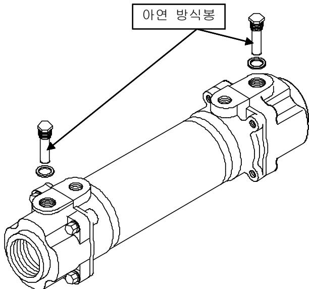
오일쿨러는 마린기어 내부의 작동유를 냉각시켜주는 장치로 냉각수로는 해수를 사용하고 있습니다. 케이스에 조립되는 쿨러고정 블록에 볼트로 장착되어 있으며 유압펌프로부터 공급된 오일을 냉각시켜 2차 오일필터로 보냅니다.
