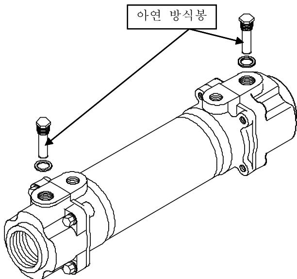
오일쿨러는 마린기어 내부의 작동유를 냉각시켜주는 장치로 냉각수로는 해수를 사용하고 있습니다. 케이스 커버 위에 볼트로 장착되어 있으며 유압펌프로부터 공급된 오일을 냉각 시켜 2차 오일필터로 보냅니다.
