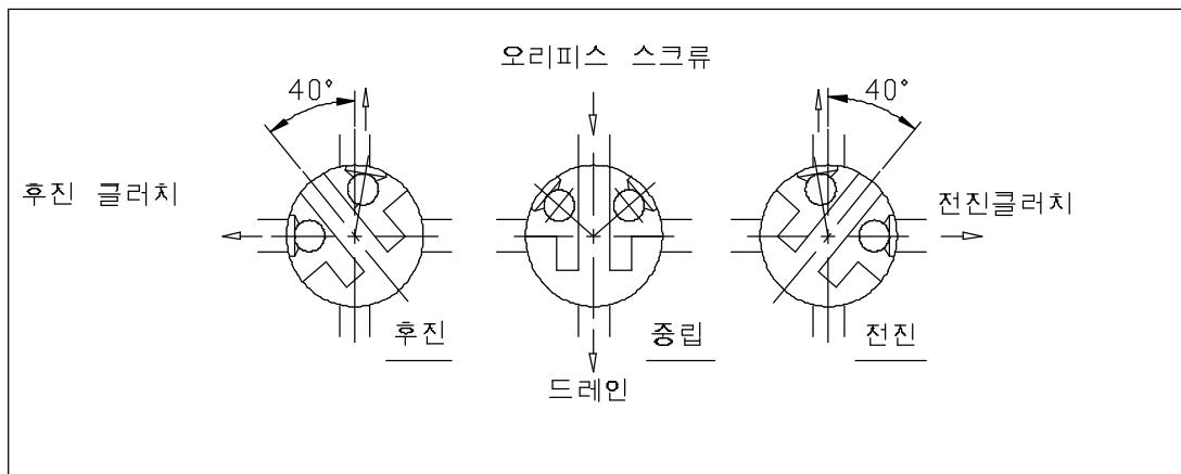
[그림-5 변환밸브 구조] -(그림6의 단면 A-A)
