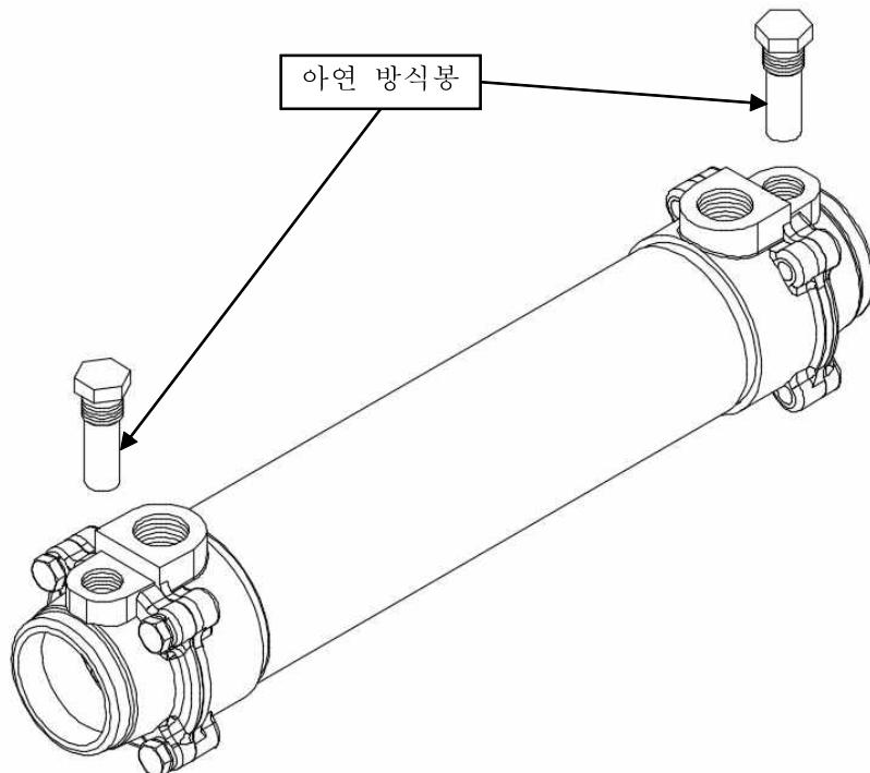
오일쿨러는 마린기어 내부의 작동유를 냉각시켜주는 장치로 냉각수로는 해수를 사용하고 있습니다. 케이스커버에 조립되는 쿨러고정블록에 볼트로 장착되어 있으며 유압펌프로부터 공급된 오일을 냉각시켜 2차 오일필터로 보냅니다.
