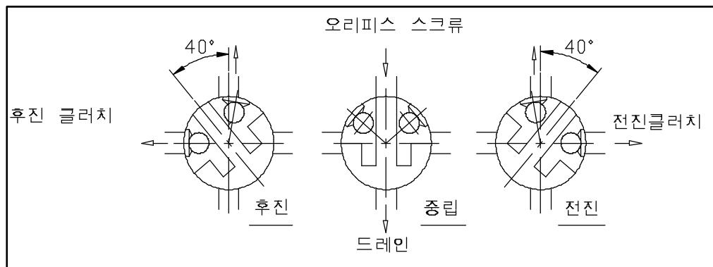
[그림-5 변환밸브 구조] -(그림6의 단면 A-A)
